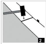
Danach klicken Sie die nächste Diele am Kopfende an, bis diese durch leichtes Klopfen mit einem Gummihammer in der Verbindung verriegelt und eben auf dem Boden aufliegt. Dies wiederholen Sie, bis Sie am Ende der ersten Reihe angelangt sind. Wichtig ist, dass die erste Reihe plan liegt. Wir empfehlen, diese zu beschweren.
