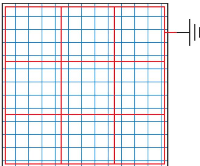
Beispiel für Verlegung des Kupferleitbands bei
