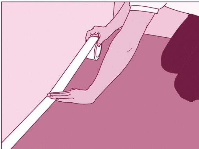
**Achtung: Wenn das Plurafilm ESD Randtape eingesetzt wird, ist über ein Kuperleitband eine Verbindung herzustellen.**
