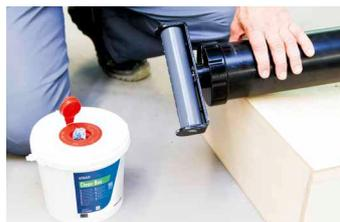
2. Düsenhalter abschrauben und Schlauchbeutel entfernen.
