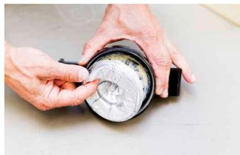
3. Entfernen der UZIN ATD Düse durch das Lösen der beiden Arretierungsschrauben an der Oberseite der Halterung.
