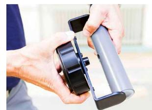
4. Entfernen aller Klebstoffreste mit Hilfe der UZIN Clean-Box, welche sich an dem UZIN ATD 100 befinden.
